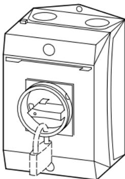
Los interruptores para mantenimiento se instalan en máquinas o instalaciones con el fin de hacer posibles las tareas de mantenimiento de acuerdo con las normas de seguridad.
